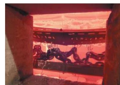
ОКЛ представляет совокупность огнестойких кабелей, проложенных и зафиксированных в огнестойких лотках различных типов. Кроме прямых секций в состав ОКЛ входят сертифицированные углы, подвесы, настенно-потолочные кронштейны, кабельные скобы, прижимы и хомуты. В зависимости от несущей способности лотков и аксессуаров, а также от типа кабеля, потребитель может спроектировать линию на 5 доступных пределов огнестойкости: E15, E30, E45, E60, E90.
